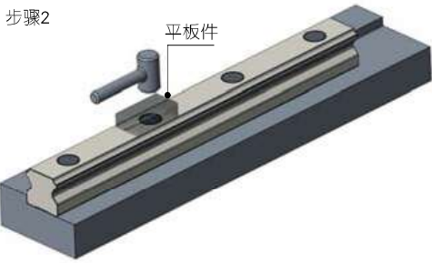
将平板件放置在螺栓孔上， 用塑料锤垂直敲击平板件， 将螺栓盖打入螺栓孔内。
