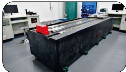
线轨综合性能检测设备
